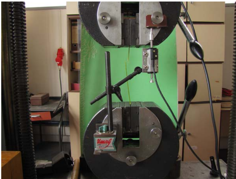
Obr. 4 Měření mechanických vlastností lněného stonku v tahu.
